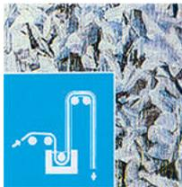
**2 -Galvanización en caliente en proceso continuo o sistema Sendzimir**, para chapa y el alambre en bobinas, mediante inmersión en un crisol o pote de zinc fundido a 450°C de temperatura, (como en el proceso anterior), pero haciendo que el contacto con el zinc sea muy breve para que la capa de zinc no sea muy gruesa igualándola o limitándola además con un escurrido posterior.
